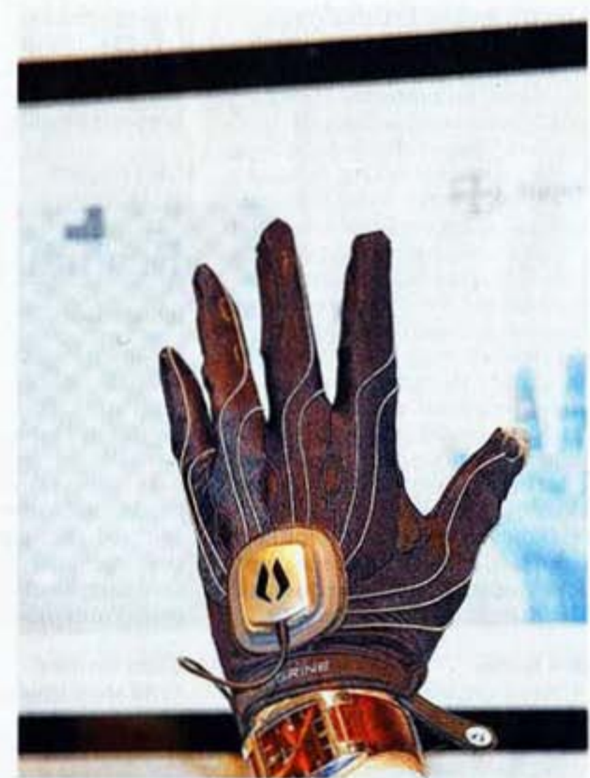
Der Handschuh Peregrine könnte in Zukunft die Computermaus bei fast allen Funktionen ersetzen. FOTOS: MESSE
