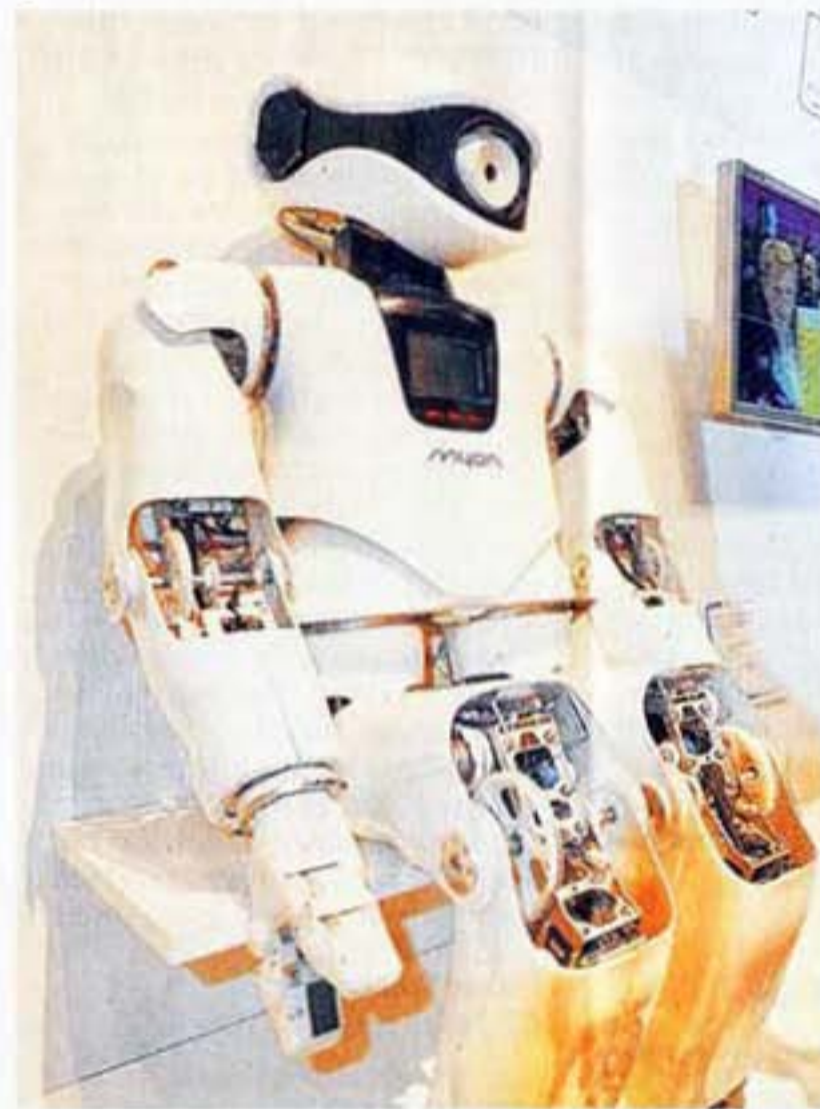
Roboter Myon ist so groß wie ein Kind. Er kann Gegenstände erkennen und mit dem Auge verfolgen.
